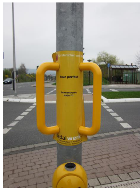
Abbildung 28: Beispielbild: Haltegriff an einem LSA-Mast.
